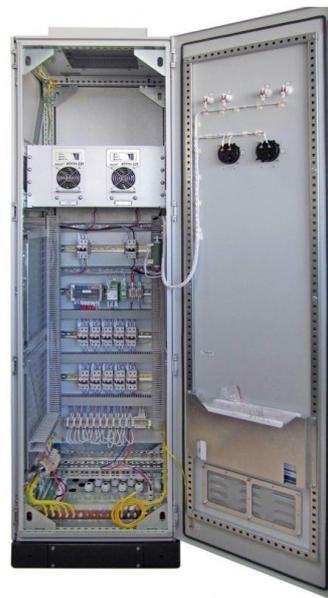
Источником гарантированного питания с возможностью автономной работы не менее 2 часов на подстанциях является система оперативного постоянного тока (СОПТ) с аккумуляторными батареями, поэтому в качестве преобразователя для шкафа питания цепей ОБР применяются DC/DC-конвертеры с гальванической развязкой серии ИППН 220
